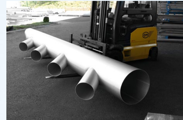
Projekt Sri Lanka: Abwasserverteiler DN500 mit 4 Abgängen, DN250
