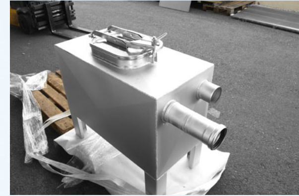
Projekt Baxter Wien: Prozessabwasserbehälter, 1.4301
