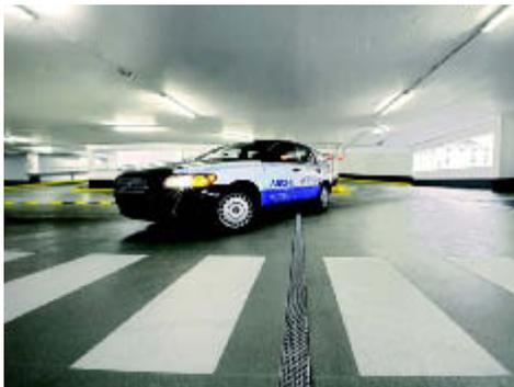
Die aus Edelstahl gefertigte Parkdeckrinne wird standardmäßig in Längen von 500 bis 6000 mm und in Breiten von 100, 150 und 200 mm produziert. Sondermaße sind ebenfalls möglich. Die Einbauhöhe liegt bei 60 mm.
