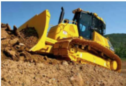
Die größte Innovation ist jedoch die intelligente Maschinensteuerung, die als revolutionär bezeichnet werden kann. Die 3D-Maschinensteuerung mit globalem Navigationssatellitensystem ist bereits ab Werk installiert und befindet sich nicht wie üblich auf dem Schild, sondern ist auf dem Dach der Raupe
