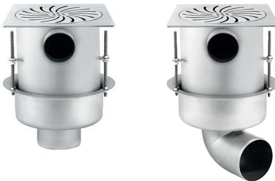
Die zweiteiligen Sanitärabläufe sind zusätzlich noch drehbar und um 10° neigbar, wodurch eine maximale Anpassung ermöglicht wird. Die Ausführung „KO“ ist zusätzlich mit einem Klebeflansch und die Ausführung „PU“ mit einem Pressflansch ausgeführt.
