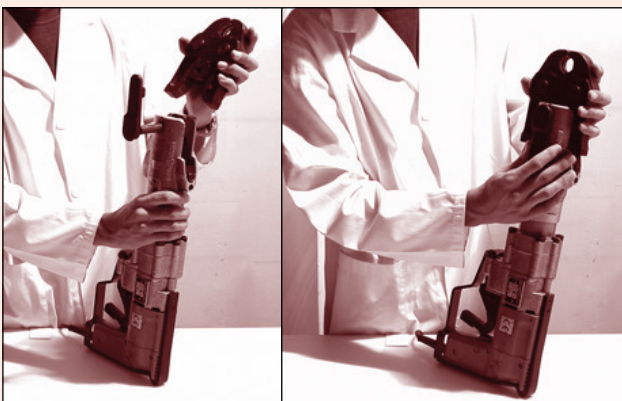
Fig. 27 | Ausrüstung der Presswerkzeuge Pressing tool assembly
