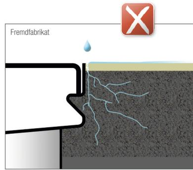
Schmutzwasser sickert bei Dehnungsrissen
