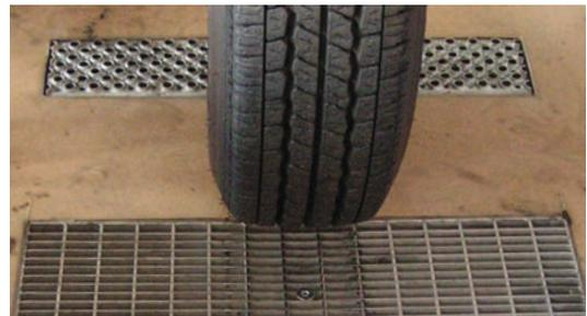
Abdeckung Belastungstest SECURIN®: nach 3 085 020 Überfahrten unbeschädigt!
