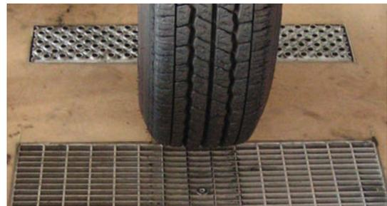
Abdeckung Belastungstest SECURIN®: nach 3 085 020 Überfahrten unbeschädigt!
